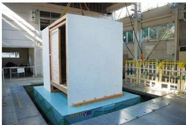
振動実験における装置全景
