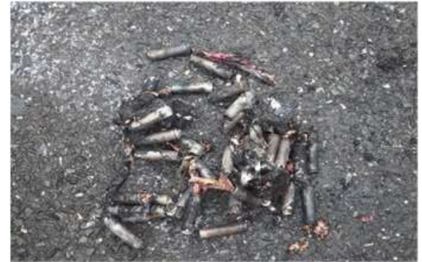
锂离子电池的烧损情况
