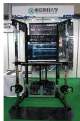
知的な筋トレ装置「WING PROTO」。高齢者からアスリートまで、一人ひとりの筋力・体力に応じた最適な運動メニューを自動的に提供することを目指す。
