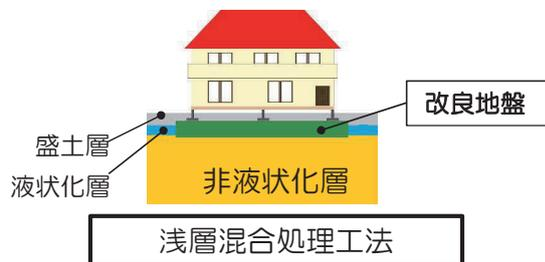
建物下部の液状化層に土とセメント系固化材などを混ぜて、層状、板状に改良する工法です。
