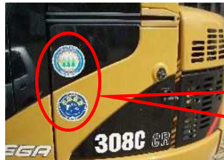
使用重機 (低騒音型重機)
