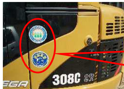
使用重機 (低騒音型重機)
