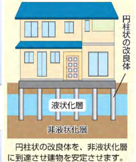
対策工事の例
