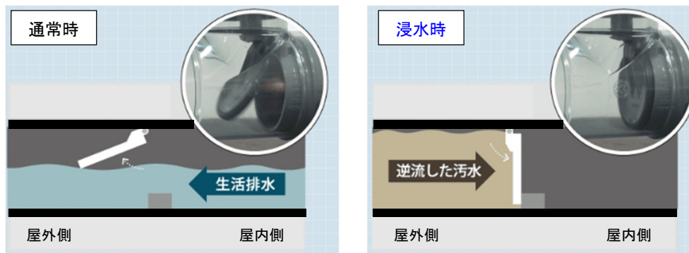
排水管の逆流防止弁のイメージ
