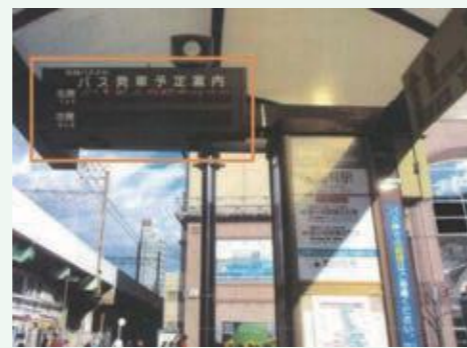
バス停のバスロケーションシステム表示機の例
