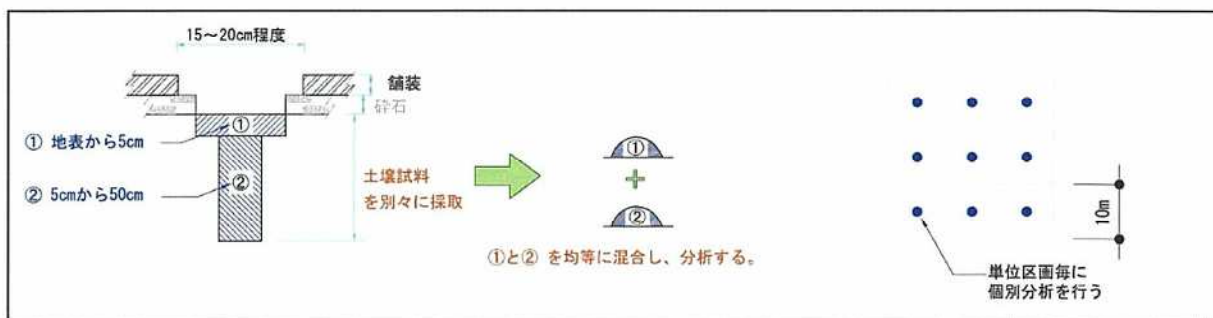
土壌汚染が存在するおそれが比較的多いと認められる土地（単位区画）での表層土壌調査イメージ図
