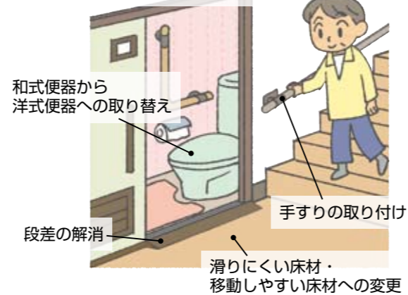
開き戸から引き戸等への扉の取り替え (ドアノブの変更・戸車等の設置)
