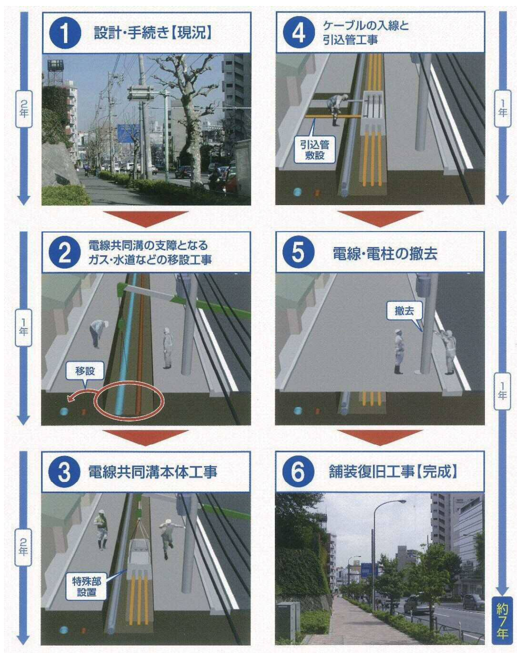
図 2.4 電線共同溝方式（一般方式）における事業の流れ
